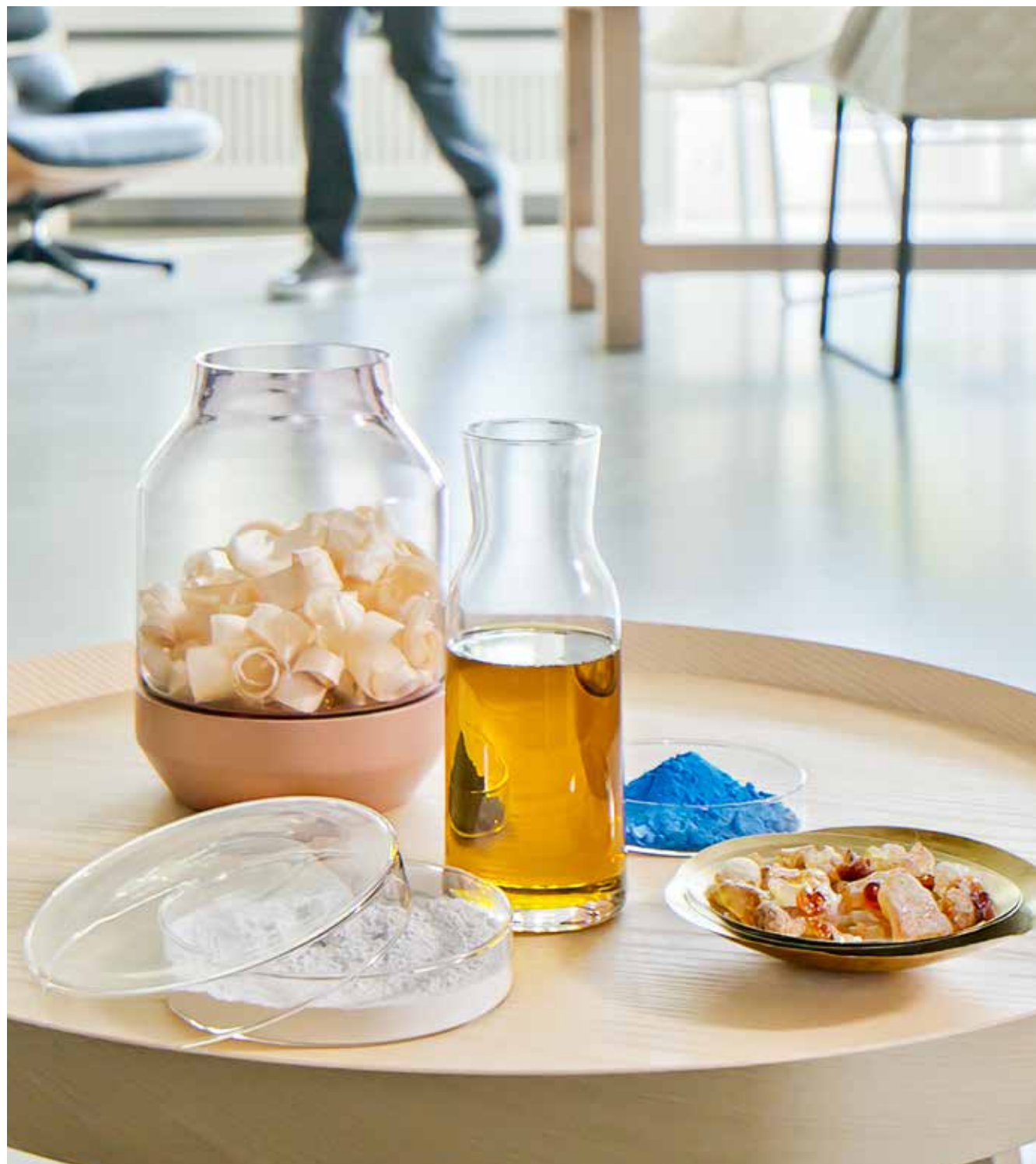
Marmoleum Modularin tärkeimpiä raaka-aineita ovat pellavaöljy, puujauho, hartsi, kalkkikivi ja pigmentit.
